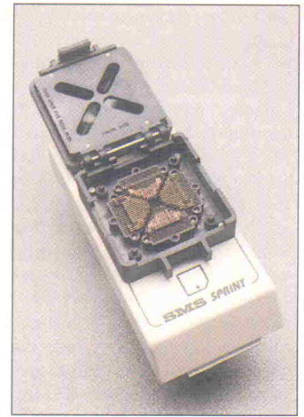
Bild 3. Zum Einpassen der PLCC-Gehäusegrößen muß man Platten auf den Universaladapter von SMS legen.
